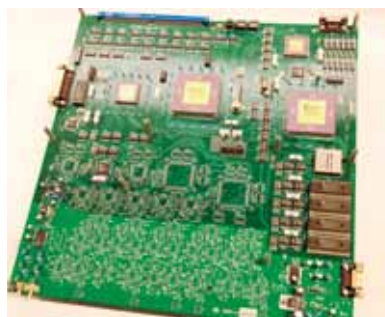
月周回衛星「かがや」に搭載された月レーダサウンダ用受信機のデジタル信号処理基板<評価試験用>(東北大学理学研究科惑星プラズマ・大気研究センター開発)
