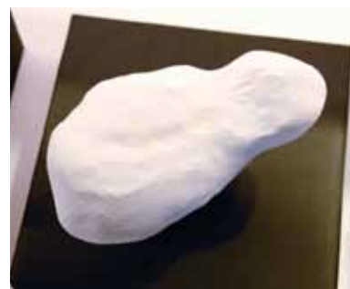
小惑星イトカワの「会津」形状モデル。はやぶさが2005年9月にイトカワ到着後に撮影した画像から、会津大学を中心とする研究チームが最初期に作成したイトカワの形状モデル。このモデルをもとに着陸地点の決定と探査機の誘導がおこなわれた。縮尺：約1/2200(会津大学製作)
