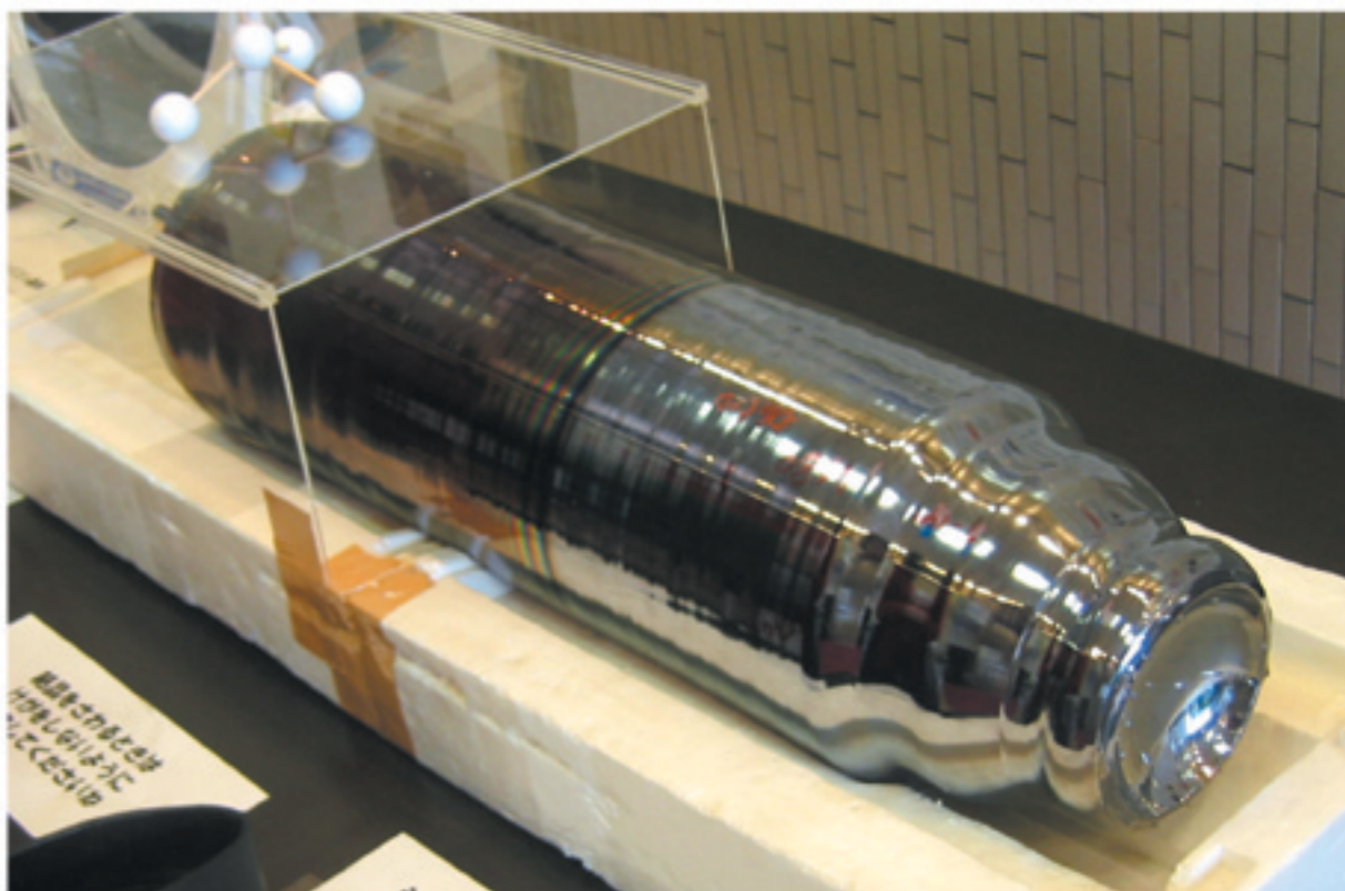
巨大なシリコン単結晶-直径20cm、高さ60cm、重さ55kg
