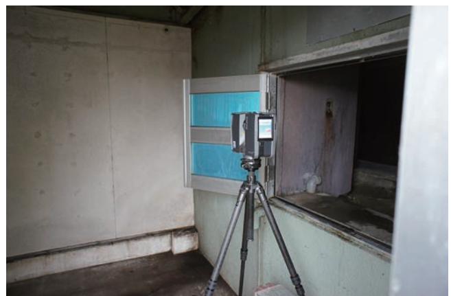
外側は地上レーザー計測・FARO 社製 Focus3D を使用
