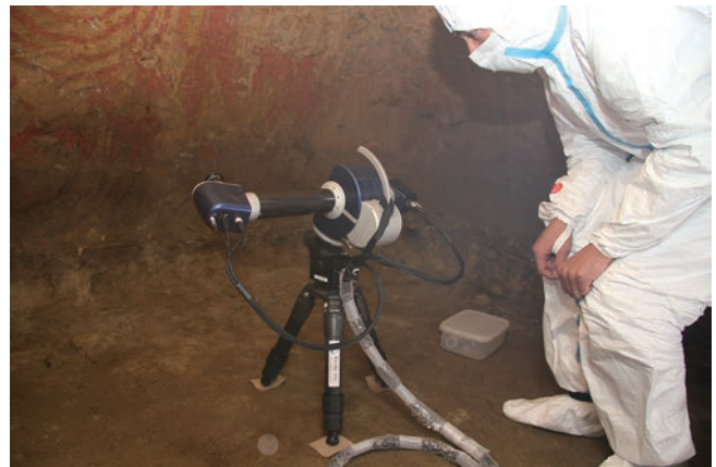
計測作業状況・三脚の下には小さく切った養生シートを敷いて床面を保護
