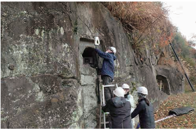
3. ハンディ 3D スキャナ（Artec Eva）での 7 号横穴の計測状況
