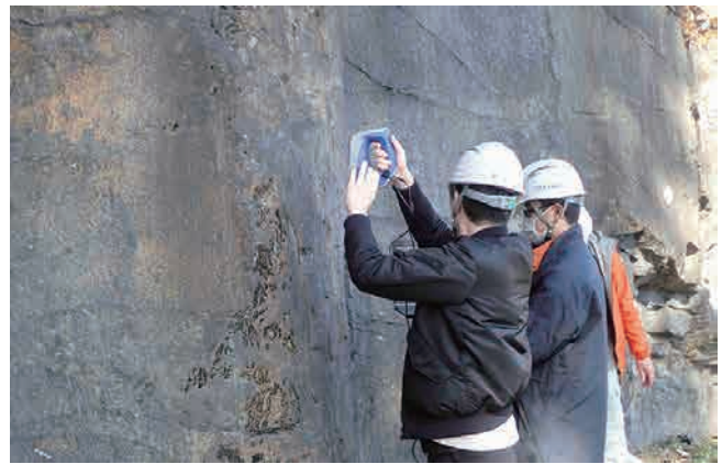
4. ハンディ 3D スキャナ（Artec Space Spider）での 11 号横穴の計測状況
