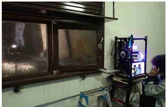
6. 計測データは横穴外に設置した PC にケーブルで接続して送信
