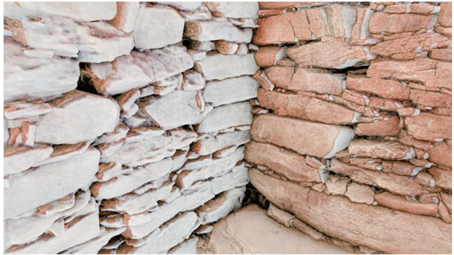
図 13 レーザースキャナによるメッシュ (白) と SfM によるメッシュ (薄茶) の差 (数 cm 程斜めにずれていることが判る)
