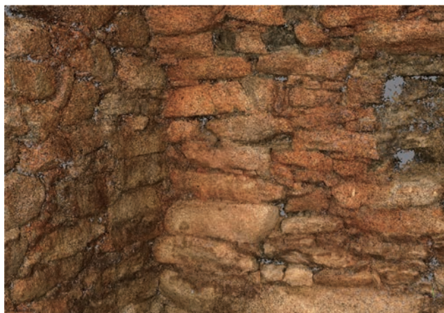
図 12 魚眼レンズ使用の SfM で生成した点群データのイメージ
